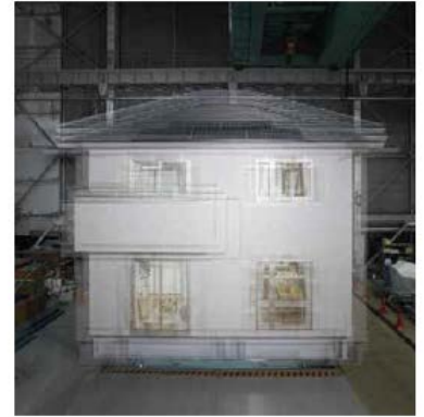
国内最大級の実験施設の油圧能力の 限界に挑戦した耐震実験
