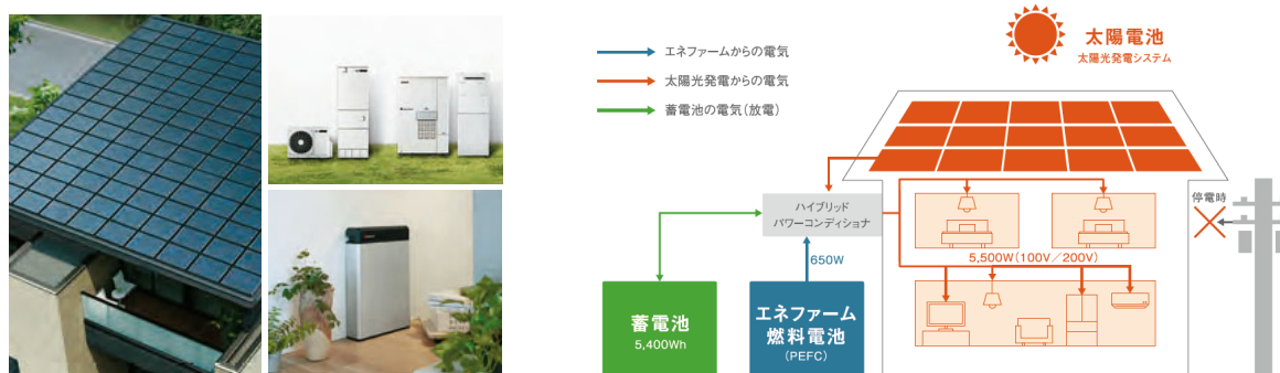
太陽電池・燃料電池・蓄電池と、全負荷型 3 電池連携システムのイメージ
