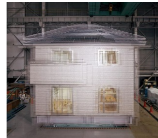
国内最大級の実験施設の 油圧能力の限界に挑戦した 耐震実験
