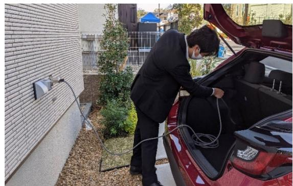
◀ 「クルマ de 給電」による給電の様子 ▶
